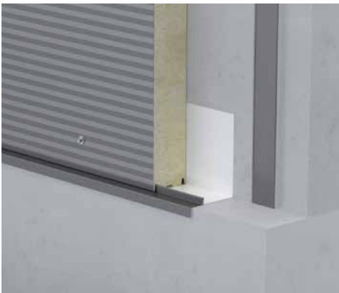
Zusätzliche Durchdringung eines Tropfkantenblechs zwischen Sandwich und Ankerschiene
