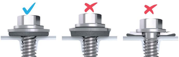
Beschädigte Dichtscheiben oder unsauber montierte Schraubverbindungen gehören damit der Vergangenheit an. So vermeiden Sie zuverlässig Nachbesserungen und Reklamationen – für dauerhaft sichere, optisch saubere und technisch einwandfreie Verschraubungen.
