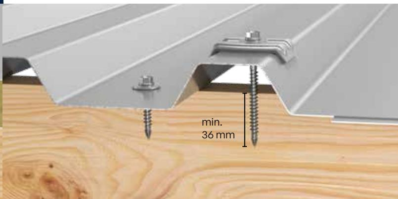
Empfohlene Einschraubtiefe: 50 – 70 mm in die Holzunterkonstruktion
