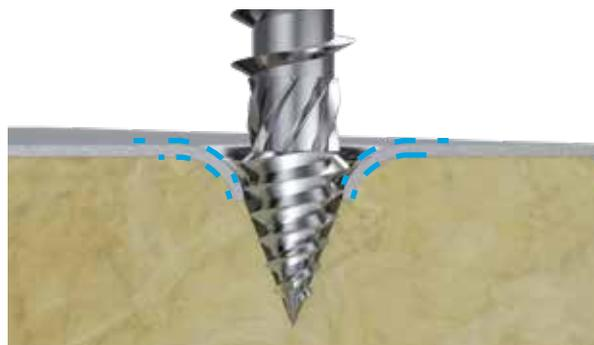
Herkömmliche Bohrschraube – Verursacht auf dem Dach Späne, die die Oberfläche beschädigen können und Korrosion hervorrufen. Bei der Fassade verursachen herabfallende Späne Korrosion auf dem Tropfkantenblech, daher ist aufwändiges Reinigen zwingend erforderlich.
