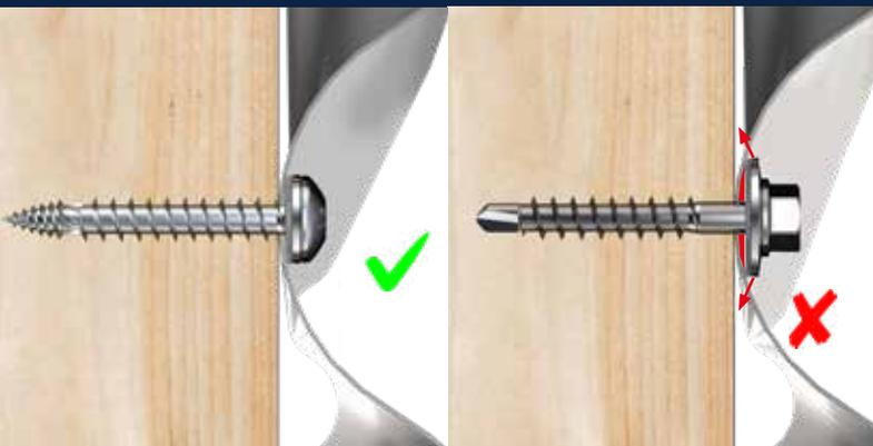
Kleine Dichtscheibe (E12) passt sich an schmale Sinuswellen an für hohe Dichtigkeit. Unauffälliger kleiner Flachrundkopf sorgt für schöne Optik.
